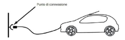
Punto di connessione costituito da una presa fissa che non è parte di un EVSE installato in modo fisso
