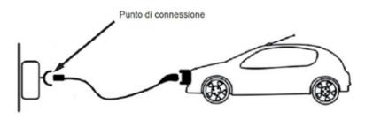
Punto di connessione costituito da una presa fissa che è parte di un EVSE installato in modo fisso
