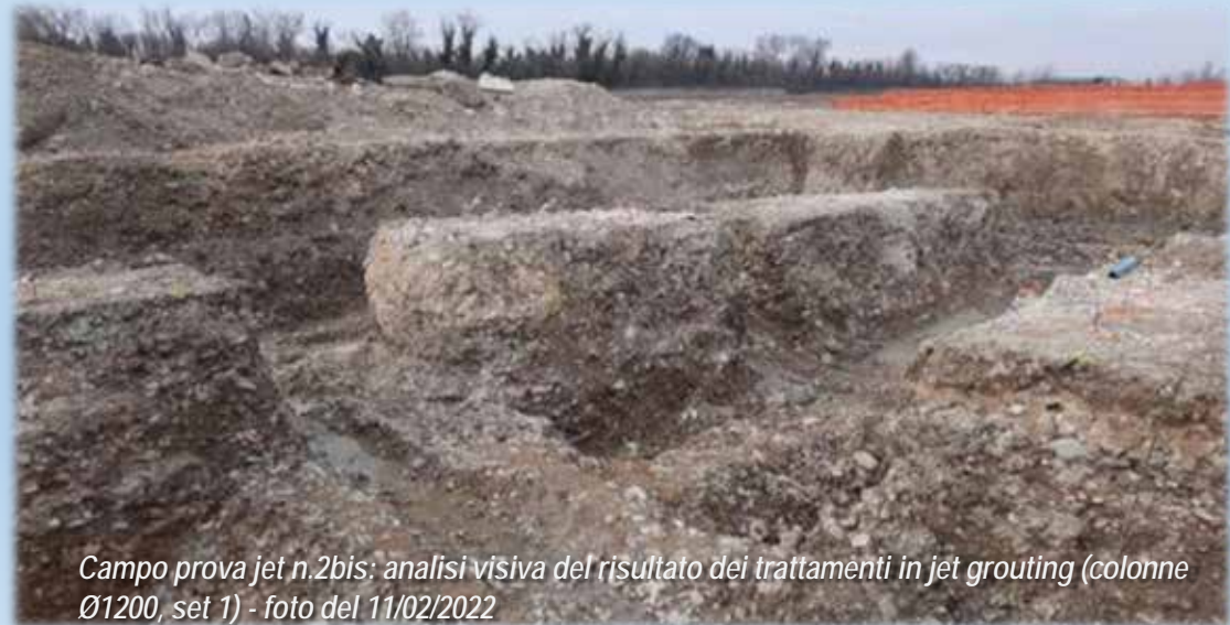
Campo prova jet n.2bis: analisi visiva del risultato dei trattamenti in jet grouting (colonne Ø1200, set 1) - foto del 11/02/2022
