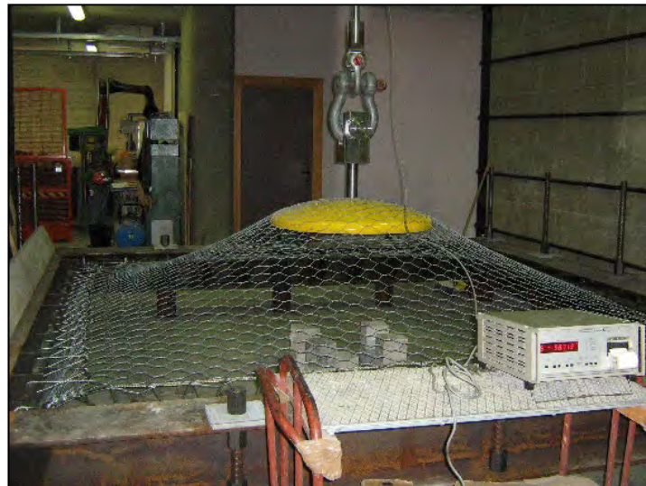
Prova di punzonamento
