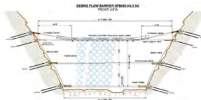
BARRIERA DFB 085-H4.5-SC Capacità max. 85 kPa
