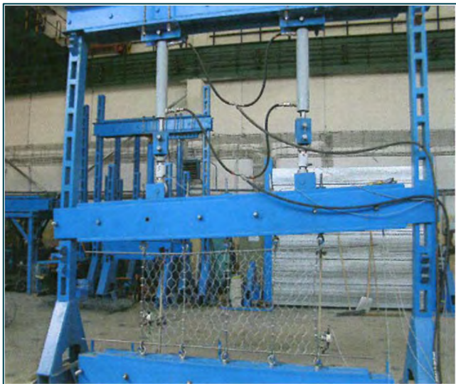
Prova di trazione
