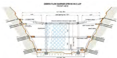
BARRIERA DFB 165-H4.5-LCP Capacità max. 165 kPa
