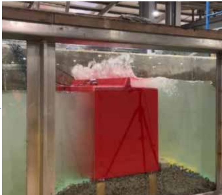
Modellazione 2D – T1 ANTI REFLECTION CELLS
