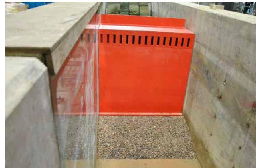
Modellazione 2D – T1 ANTI REFLECTION CELLS
