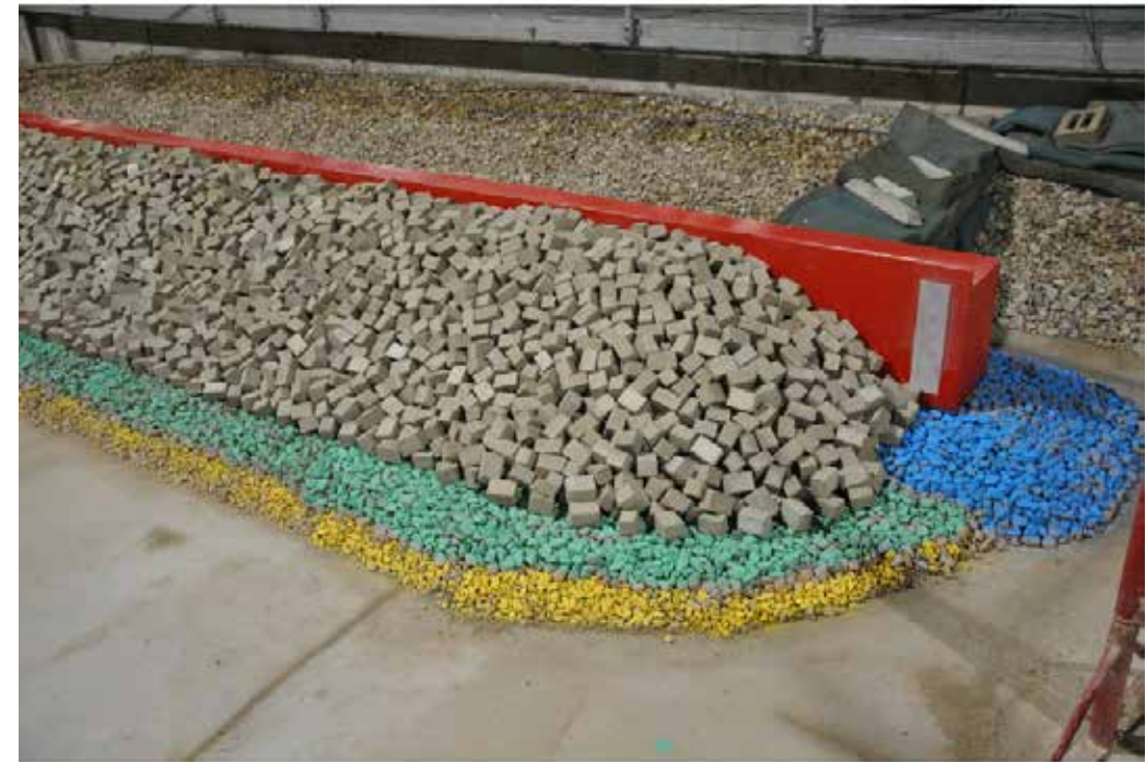
Fotografia 5.5: Testa tonda orientale della diga della sezione T6
