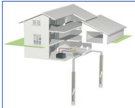
Sonde geotermiche verticali
