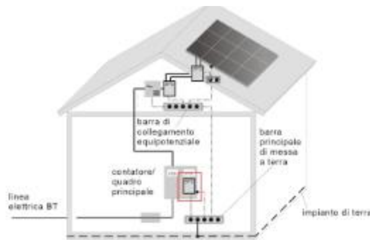
Figura 6-1 – Edificio e impianto FV senza LPS esterno
